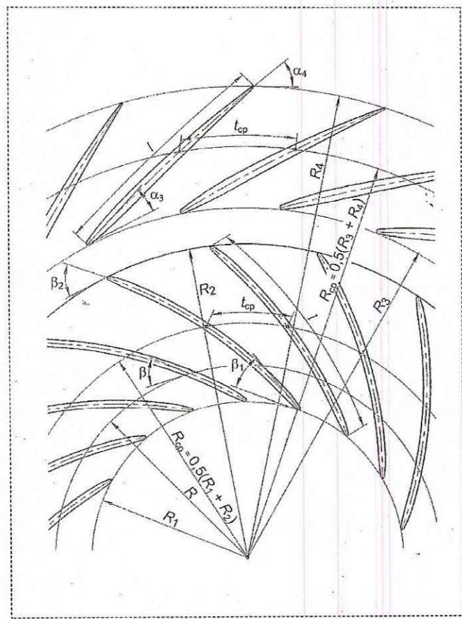
Рис. 1. Лопаточные решетки колеса и лопаточного диффузора
