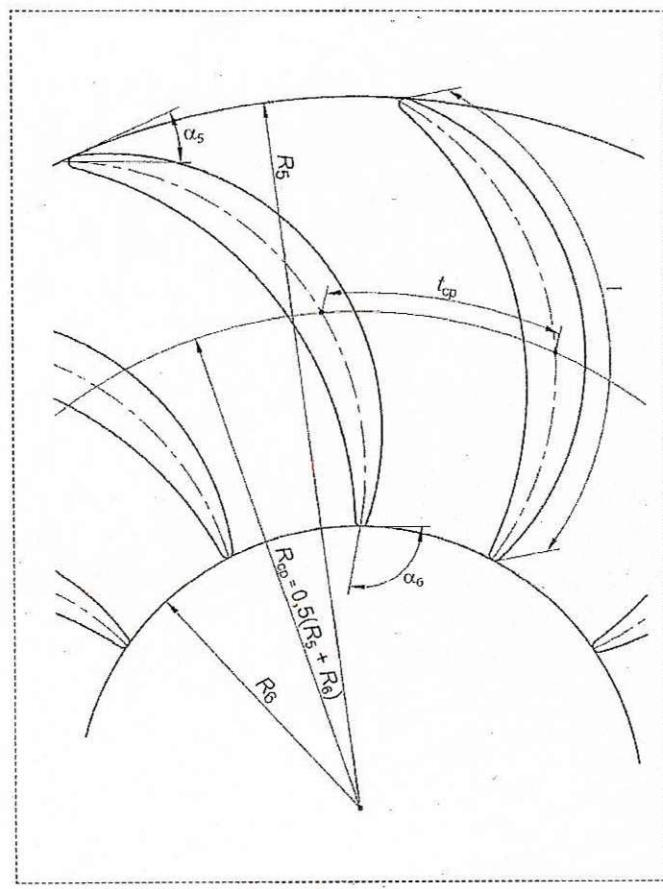
Рис. 2. Лопаточная решетка обратно-направляющего аппарата
